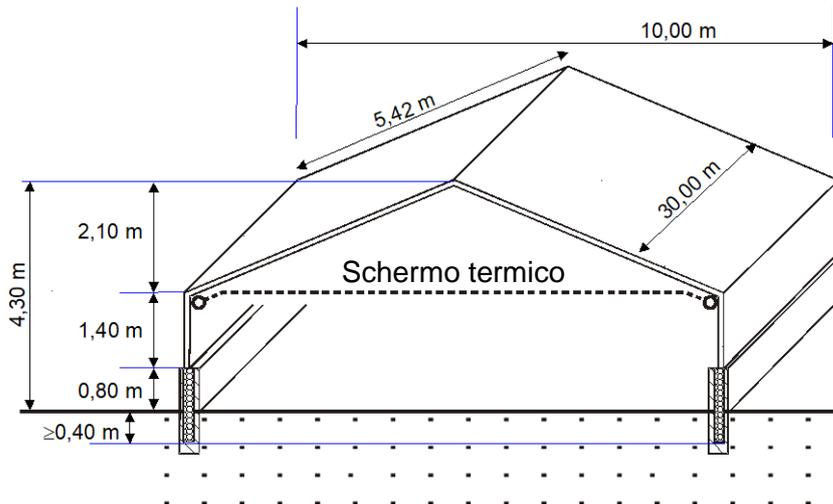
L'effetto dello schermo termico, per es. sul valore del tetto  $U_{Re}$ , si computa aggiungendo la sua resistenza termica (dovuta in parte all'irraggiamento  $R_r$  e in parte allo strato dell'aria immobile  $R_c$ ) alla resistenza termica del vetro  $R_g$  e del telaio  $R_{Fe}$ .
